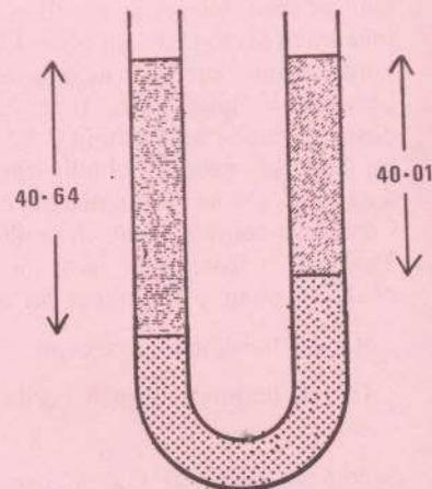
Doirtear tuilleadh alcól isteach go dtí go mbíonn an dá dhromchla mearcair ar aonleibhéal. Faigh cad é fad nua an cholún alcól go dtí an mm is gaire.
